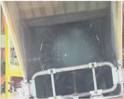
图 8 喷嘴安装角度上偏 7^{\circ}30' 的喷射效果
